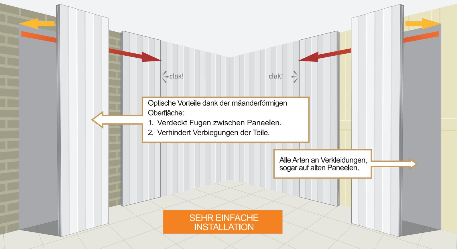
Optische Vorteile dank der mäanderförmigen Oberfläche:
